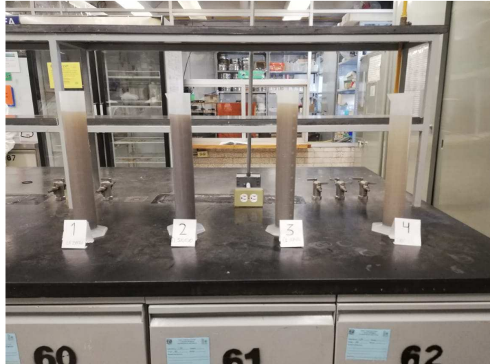
Figura 7. Muestras en el proceso de análisis granulométrico, según el método Bouyoucos.
