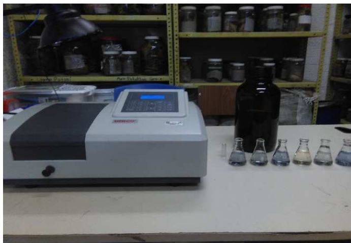
Figura 9. Espectrofotometría. Muestras coloridas del fósforo extraídas por el método Bray y Kurtz II.
