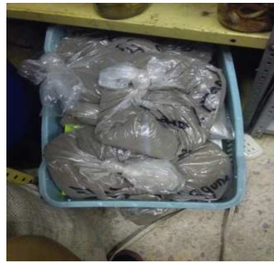
Figura 4. Almacenamiento de sedimento molido y seco.
