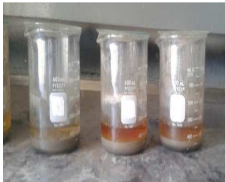
Figura 5. Muestras donde se observan el resultado físico de la eliminación de carbonatos.
