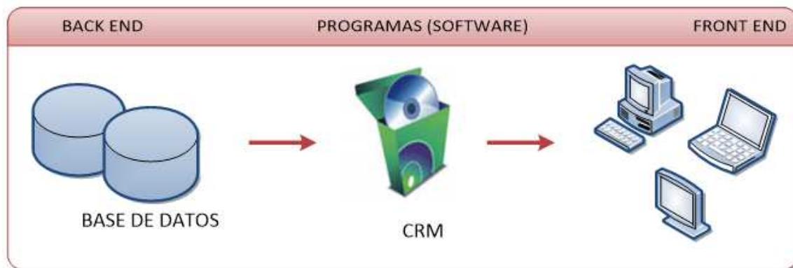
Figura 1. Arquitectura del software y hardware de CRM. 15
