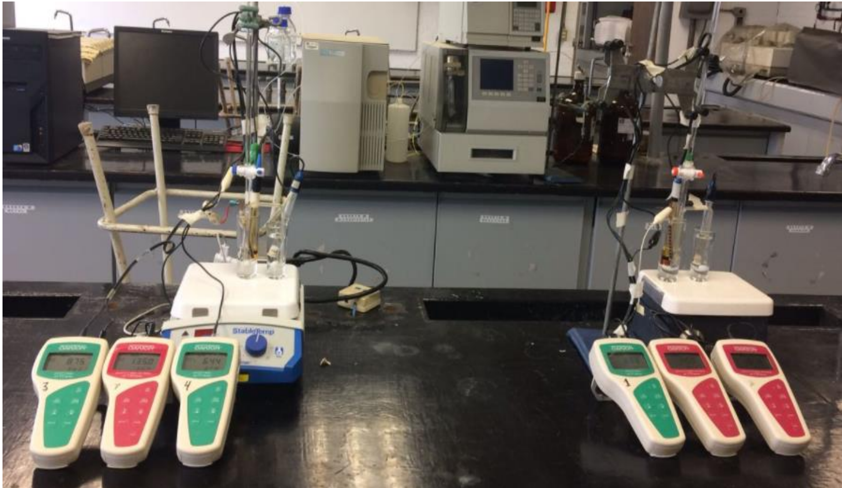
Imagen 2. Montaje experimental de la segunda etapa. Valoración de una mezcla de 5mL de yodato de potasio 0.0999M y 5mL de tiosulfato de sodio 0.10005M con una solución estandarizada de ácido clorhídrico 0.1M en un sistema en paralelo, seguida potenciométricamente con ayuda de un electrodo de vidrio, un electrodo combinado de platino y un electrodo de grafito.
