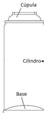
Figura 1.2 Partes de una lata de aerosol.
