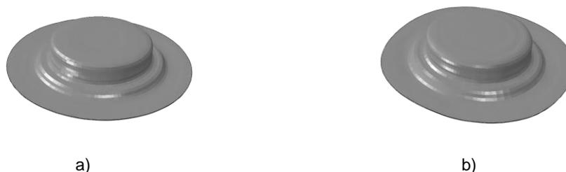
Figura 4.22 Segundo paso de embutido a) Con lámina isotrópica b) Con lámina anisotrópica
