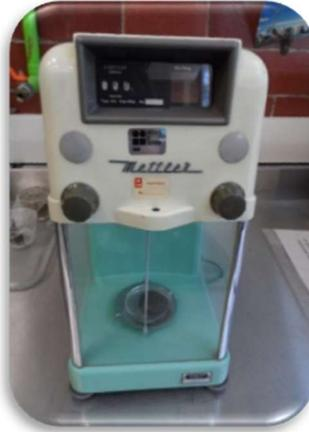
Figura 35. Registro de la masa de la muestra remoldeada.
