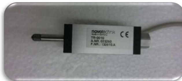
Figura 24. Sensor de desplazamiento.
