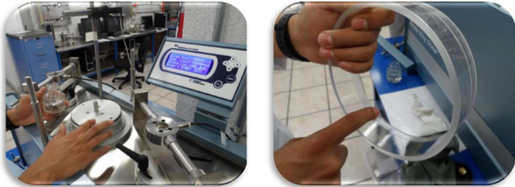
Figura 42. Lubricación con aceite de silicón.
