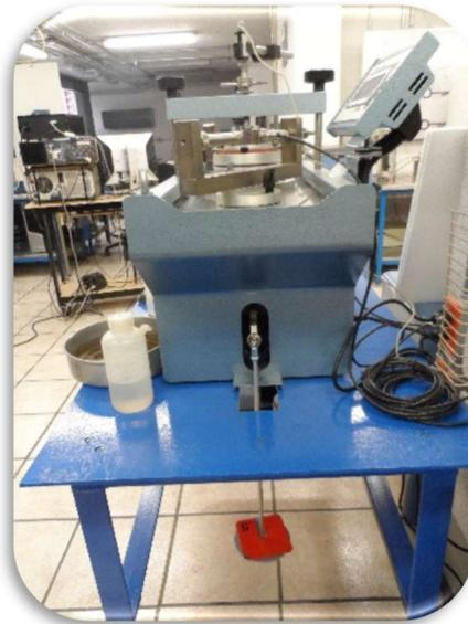
Figura 50. Portapesas del equipo Torshear.
