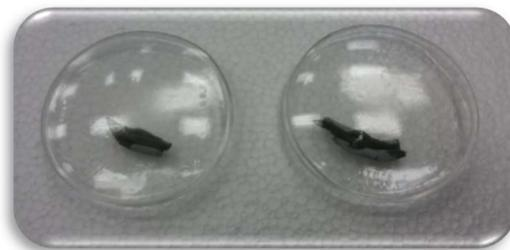
Figura 60. Determinación del límite plástico.
