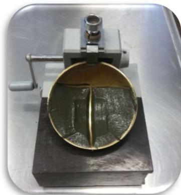
Figura 59 Determinación del límite líquido.
