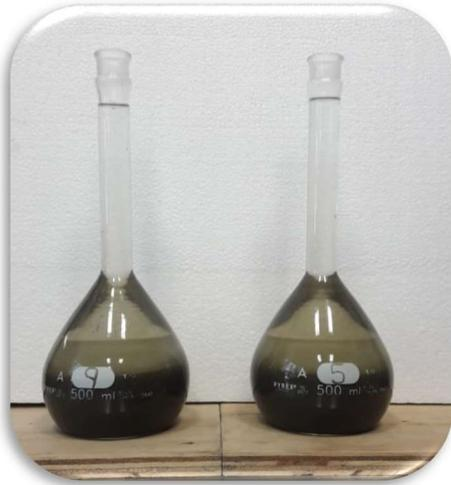
Figura 64 Determinación de la densidad de sólidos.
