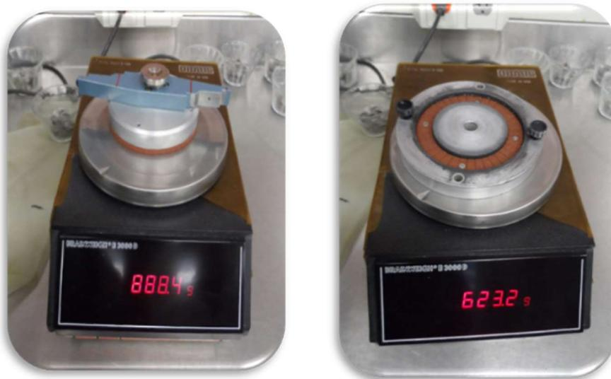
Figura 38. Registro de la masa de los platos de carga con las piedras porosas superficialmente secas.
