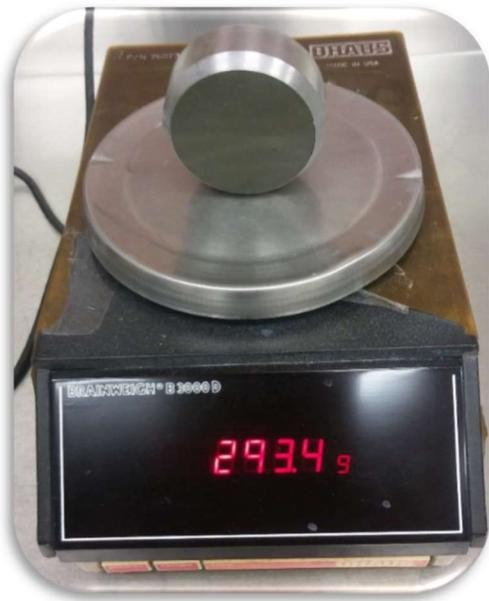
Figura 66. Pastilla para la determinación del peso volumétrico.
