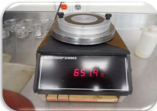
*Figura 41. Registro de la masa de la base y suelo húmedo.*
