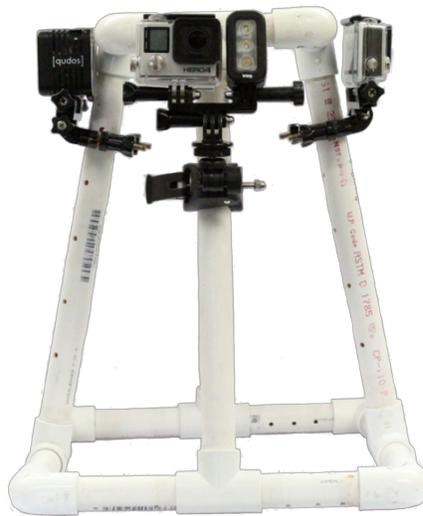
Figura 5. Sistema para la toma de video. El objetivo de la configuración de la base presentada aquí es reducir el tamaño y el peso de tal manera que pueda guardarse, transportarse y armarse fácilmente en campo.
