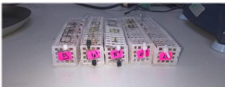
Fig. 7. Contenedores para identificación de las muestras durante la rehidratación.
