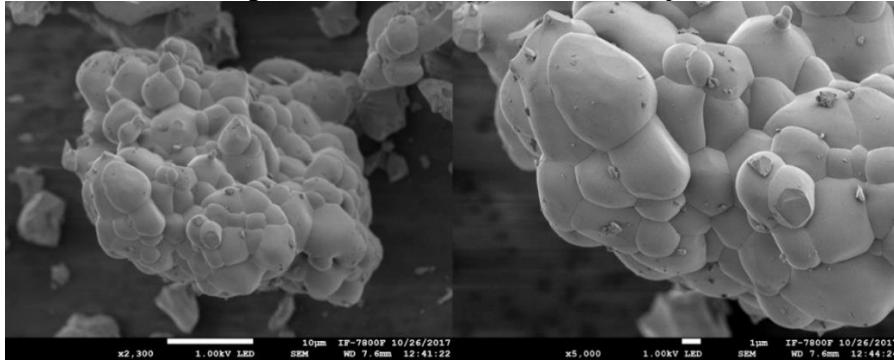
Fig. 4.17 Imágenes de SEM de la muestra Zn_{1.97}Mn_{0.03}GeO_4
