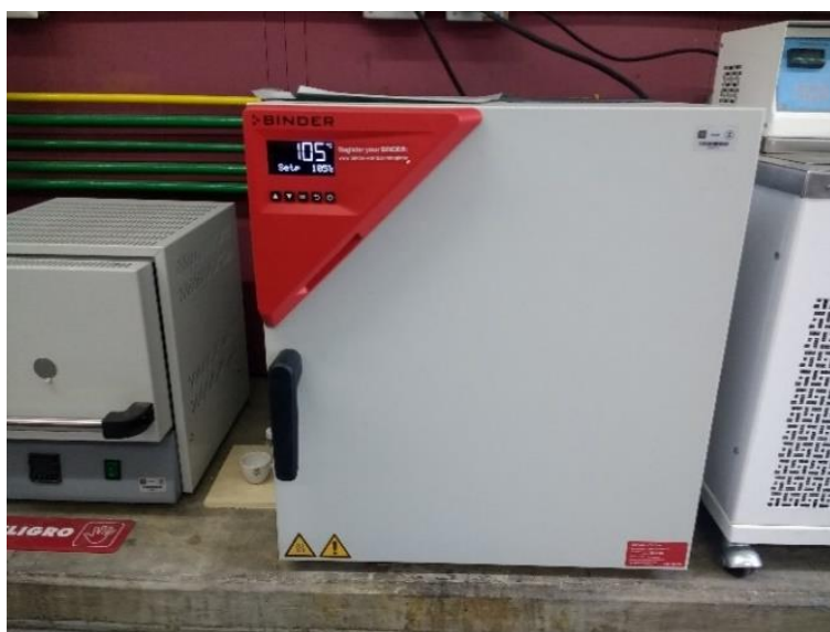
FIGURA 17. EQUIPO, ESTUFA DE SECADO POR CALENTAMIENTO A 105 °C CONSTANTES MARCA BINDER® EMPLEADA PARA EL SECADO DE MUESTRAS.
