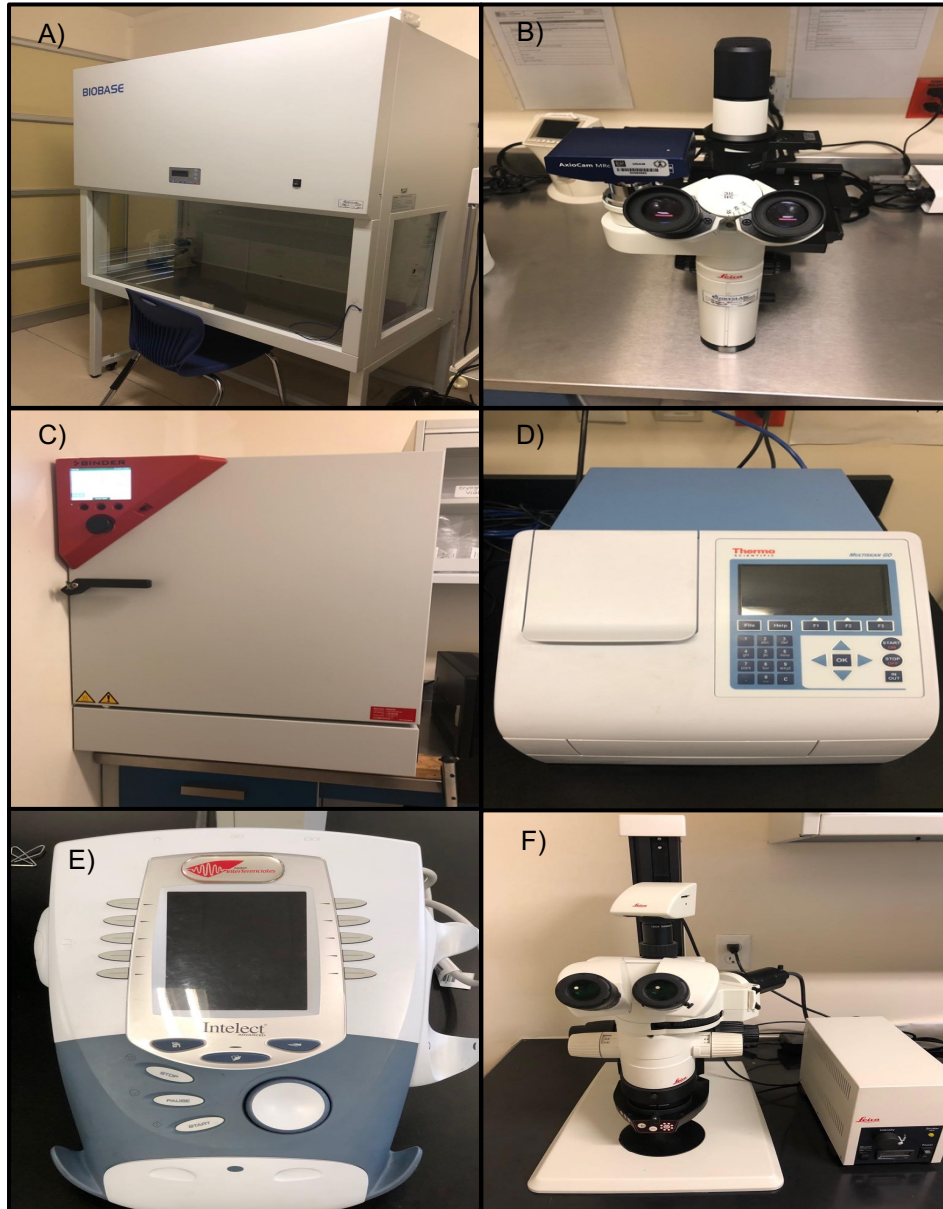
Fig. 6: Equipos utilizados en la realización del proyecto: A) Campana de flujo laminar horizontal, B) Microscopio, C) Incubadora, D) Espectrofotómetro, E) Ultrasonido Terapéutico, F) Microscopio estereoscópico de fluorescencia. Fuente directa.
