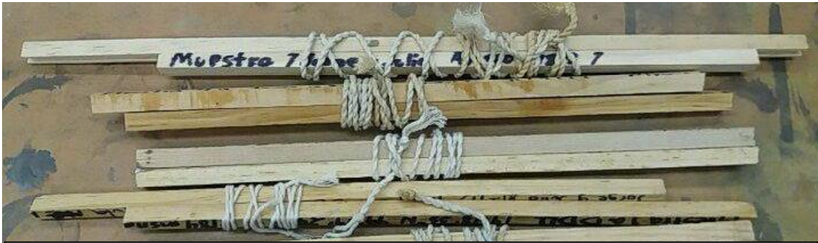
Figura 16. Montado de núcleos en bastidores de madera. Foto tomada por el autor, en Octubre 2017.
