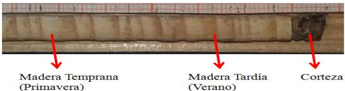
Figura 8. Núcleo extraído de pino, donde se observa las diferencias de temporada (primavera y verano) en los anillos de crecimiento. (Autor).
