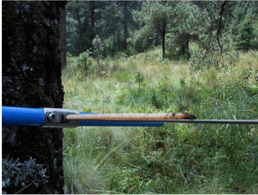
Figura 15. Extracción de los núcleos de los pinos con el taladro Pressler. Foto tomada por M. en C. Germán Calva Vásquez, en Septiembre 2017.
