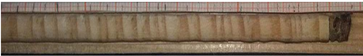
Figura 17. Lijado de madera donde se visualizan los anillos de crecimiento con nitidez y marcaje de anillos con papel milimétrico. Foto tomada por el autor, en Octubre 2017.
