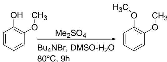
Esquema 4. Metilación con sulfato de dimetilo
