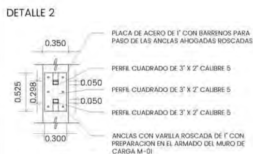
ARMADURA AR-05 SECCION I
