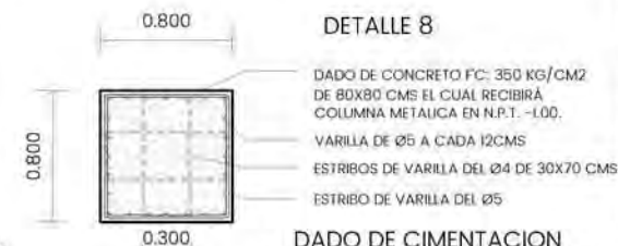
DADO DE CIMENTACION (DA-01) EN ESTACIONAMIENTO
