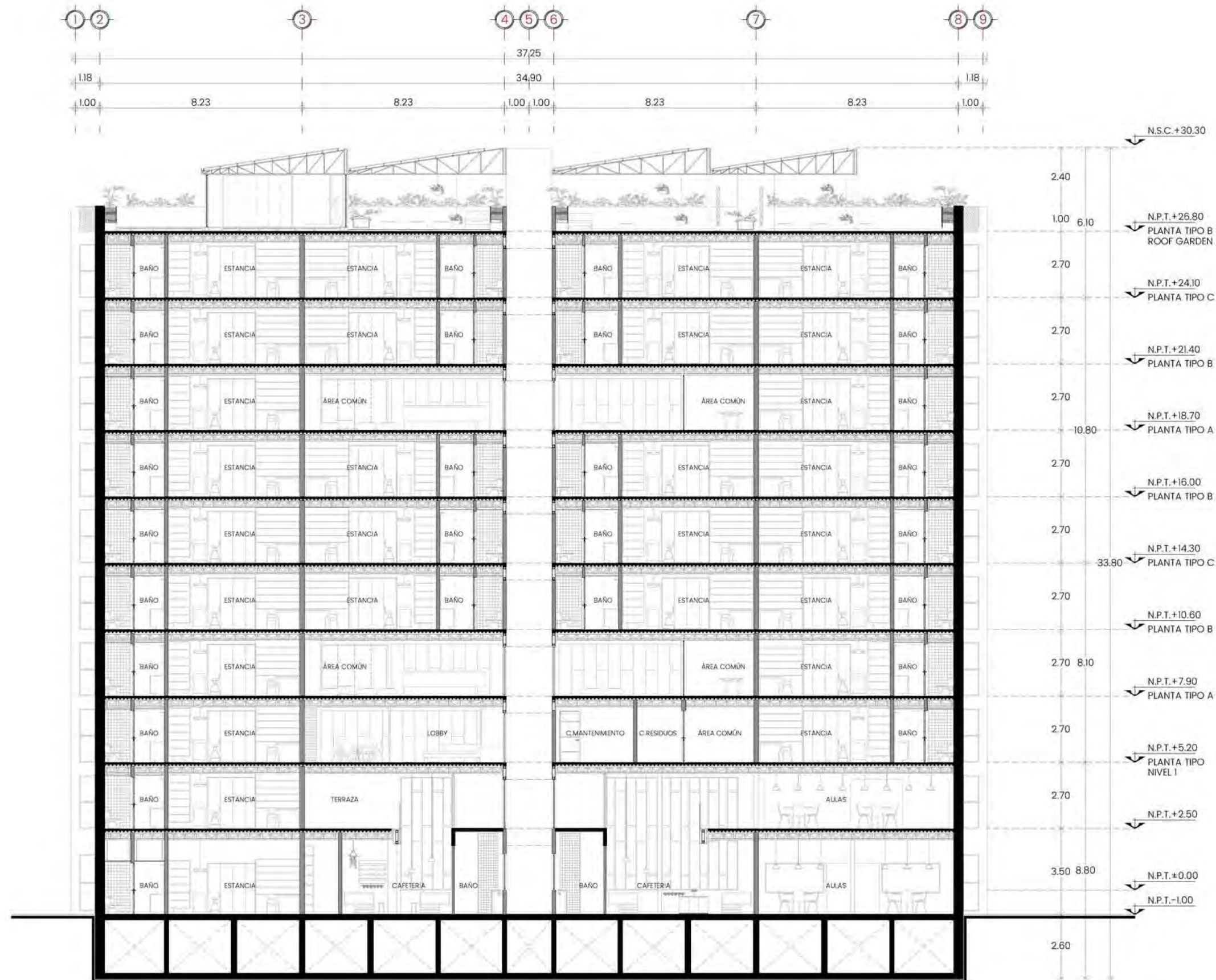
SECCIÓN ARQUITECTÓNICA - A-A' EDIFICIO 4-10 NIVELES
