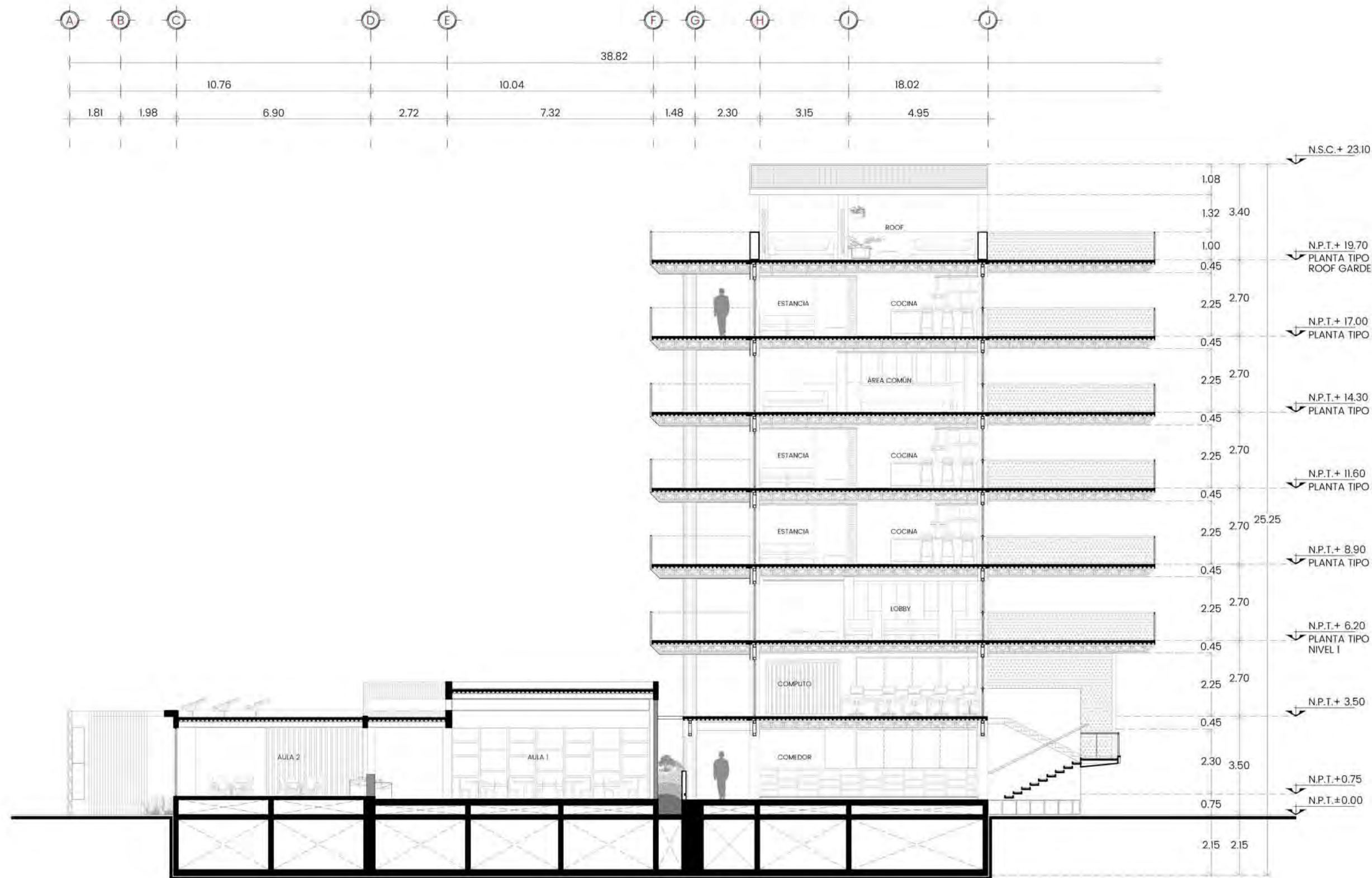
SECCIÓN ARQUITECTÓNICA-AA' EDIFICIO 1-6 NIVELES
