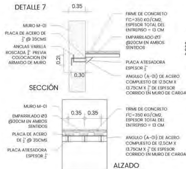
DETALLE DE ANGULO A-01 EN MURO DE CARGA M-01
