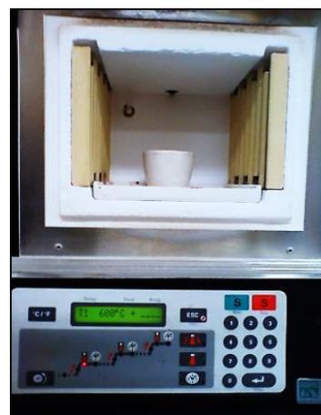
*Fig. 19.- Calcinación del Sistema Mixto de  $\text{SiO}_2\text{-FeO}$ .*
