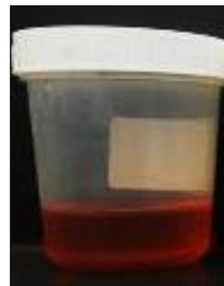
*Fig. 15.- Sol del Sistema Mixto de  $\text{SiO}_2\text{-FeO}$  recién preparado.*
