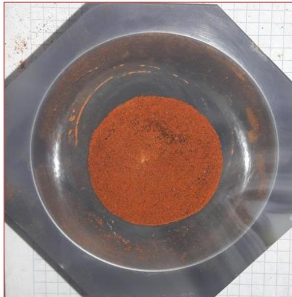
*Fig. 18.- Fase polvo del Sistema Mixto de  $\text{SiO}_2\text{-FeO}$ .*
