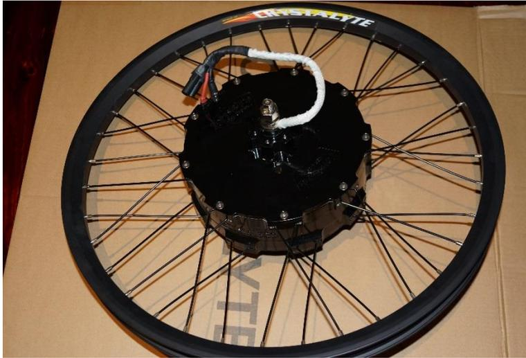
Figura 1.3 Motor BLDC montado en rueda (HUB)
