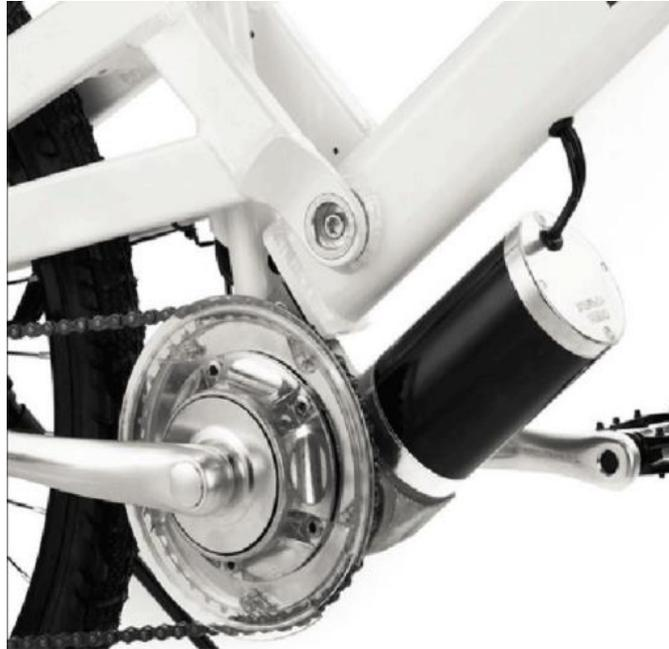
**Figura 1.2 Motor eléctrico en posición central**
