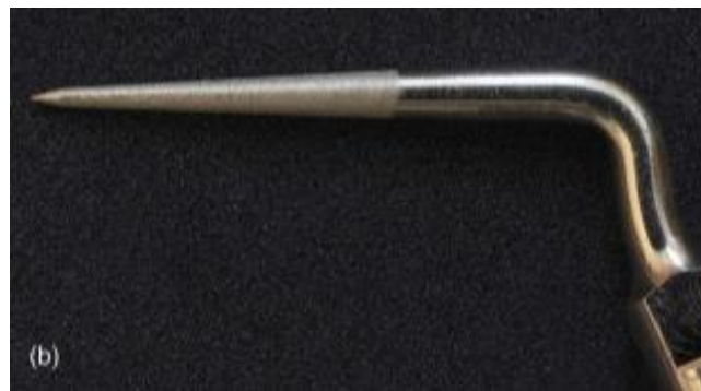
Figura 4 Recubrimiento de nitruro de zirconio en una punta ultrasónica Pro-UltraEndo- 2.
