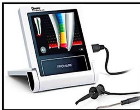
Fig.27 Localizador Electrónico Apical
