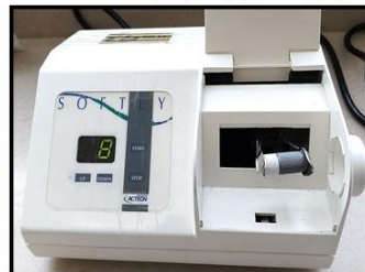
c. Colocar en el amalgamador cápsula durante 8seg.
