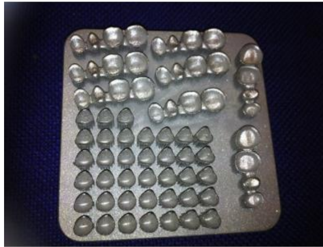
Figura 28 Restauraciones dentales hechas con fusión selectiva por láser.
