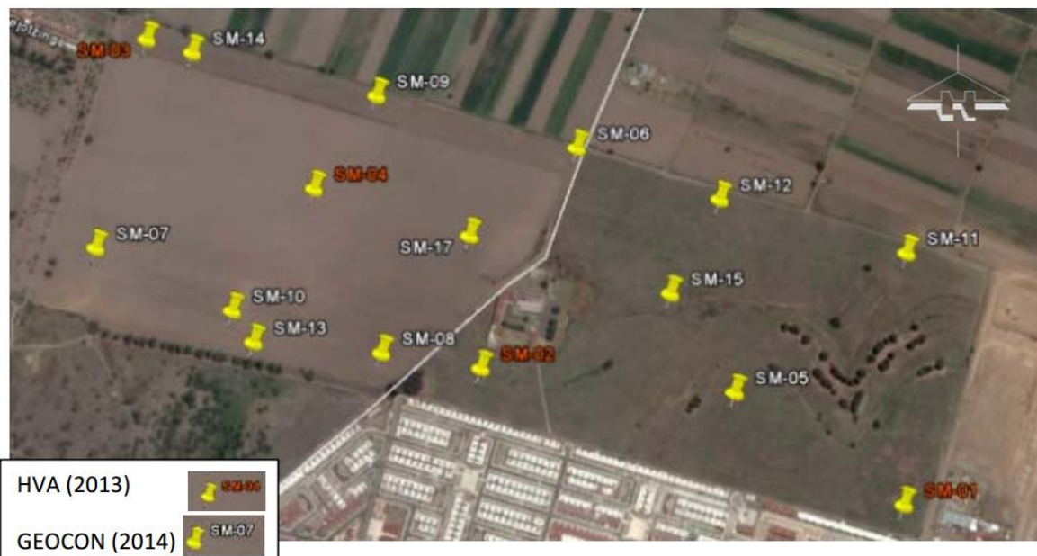
UBICACIÓN DE LOS SONDEOS MIXTOS REALIZADOS EN EL PREDIO FUENTE: ESTUDIO DE MECÁNICA DE SUELOS 2014, GEOCON
