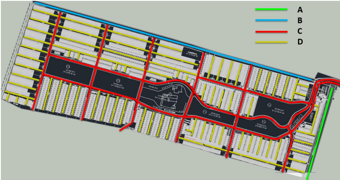
UBICACIÓN DEL TIPO DE VIALIDADES EN EL DISEÑO DEL FRACCIONAMIENTO FUENTE: ELABORACIÓN PROPIA, CON BASE EN PLANO DE LOTIFICACIÓN AUTORIZADO
