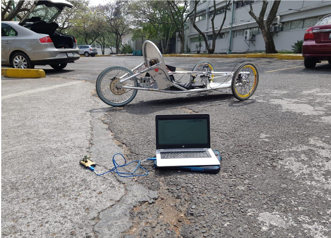
Figura 19. Auto de pruebas eléctrico junto con el sistema de retransmisión conectado a una computadora
