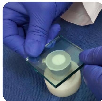
Figura 12 Ejerciendo presión sobre la muestra para desbordar material. F.D.
