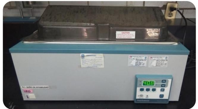
Figura 4 Cámara de ambientación de temperatura y humedad controlada Poly Science®. F.D.
