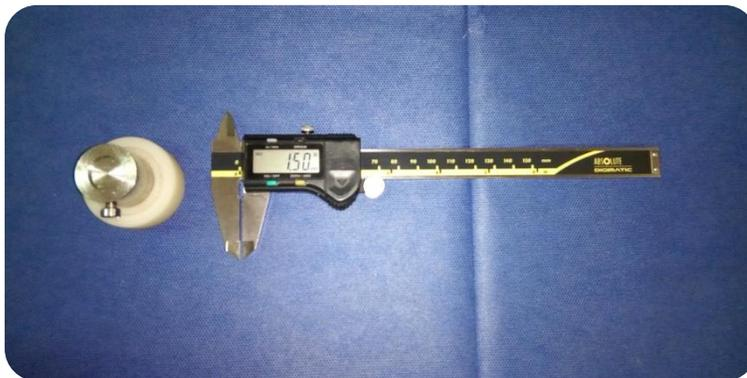
Figura 7 Hacedor de muestras de solubilidad y vernier calibrado a 1.5mm. <sup>F.D.</sup>
