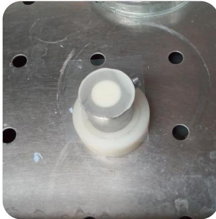
Figura 13. Colocación de la muestra en la cámara de temperatura y humedad controlada. F.D.
