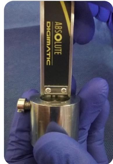
Figura 8 Medición del grosor de las muestras. <sup>F.D.</sup>
