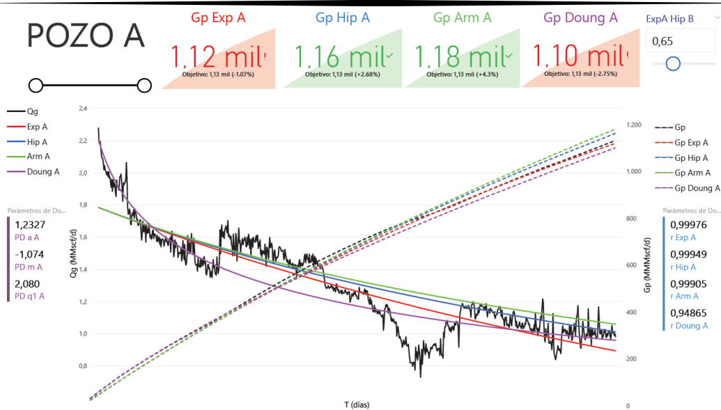
FIGURA 4. 8 COMPARACIÓN DE LAS CURVAS DE DECLINACIÓN DE ARPS CONTRA DOUNG DEL POZO A.
