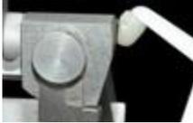
Espaciador utilizado para graduar la distancia intercondilar. 2 espaciadores a cada lado derecha e izquierda en distancia intercondilar L(large), 1 espaciador en M(medium), sin espaciador es S(small).
