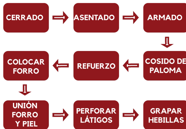
Esquema 3. Subprocesos durante el proceso de respunte Realizado por Esaúl Hernández (2017)
