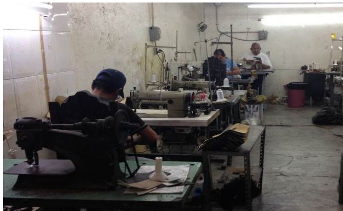
Il. 18: Proceso de respunte, en este paso es esencial el uso de máquinas de coser, en caso de que el taller no hubiera se recurre a las maquiladoras.
