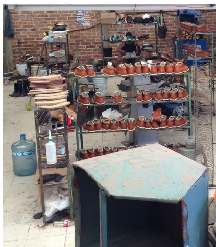
Il. 26: Proceso de secado de hormas listas para la última etapa de producción | Caso de estudio 3. Fotografía de Esaúl Hernández. (2017)
