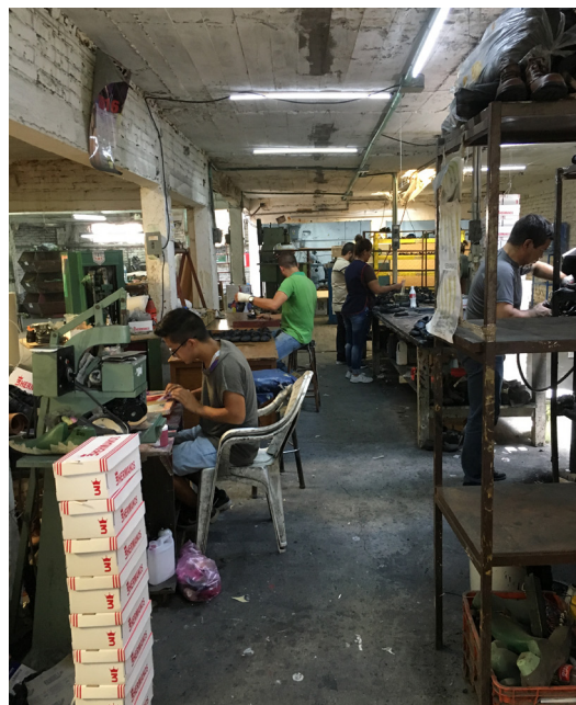
Il. 47 Línea de producción del caso de estudio 1 Proceso de Limpieza, Adorno y Embalaje en cajas Fotografía de Esaúl Hernández (2017)
