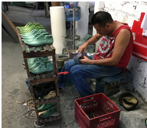
Il. 23: Proceso de montaje de hormas de manera manual | Caso de estudio 1. Fotografía de Esaúl Hernández. (2017)
