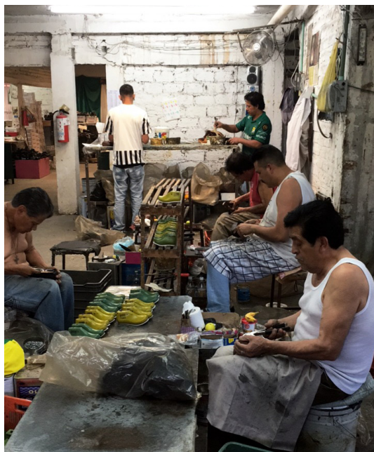
Il. 48 Línea de producción del caso de estudio 1 Proceso de rebaja, compostura y montado de horma Fotografía de Esaúl Hernández (2018)
