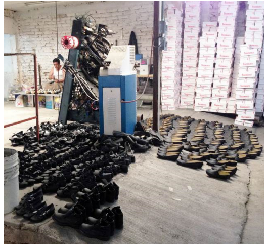
Il. 26: Calzado desmontado, en espera para el proceso de adorno y de ojillos para agujetas. Fotografía de Esaúl Hernández. (2017)
