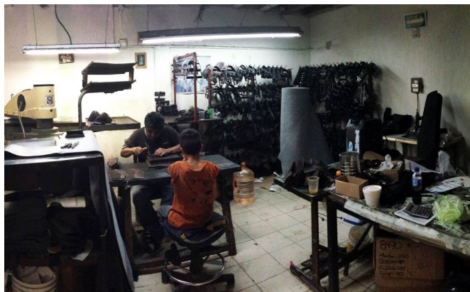
Il. 14: Proceso de cortado manual e industrial en taller familiar Izquierda: Mesa de corte y máquina para suajar. Derecha: Estantería con los suajes utilizados para la maquinaria. Centro: Obrero y su hijo en el proceso. Fotografía por Esaúl Hernández (2016)
