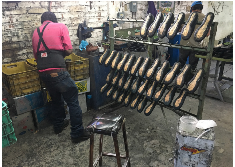
Il.37: Colocación y preparación de zapatos utilizando el pespunte y hormas. | Taller Caso 1 Fotografía por Esaúl Hernández (2017)
