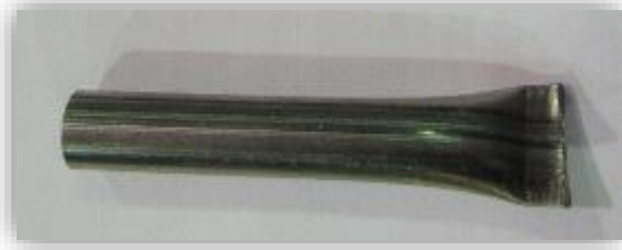
Figura 2.6. Capsulas para el antiesferoidizante (FeTi), se muestra una capsula sellada por la parte inferior, antes de agregar el material.
