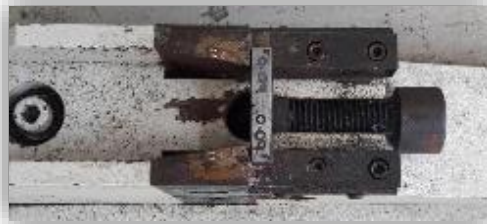
Figura 2.21. Posición de la probeta de impacto (norma ASTM E23).
