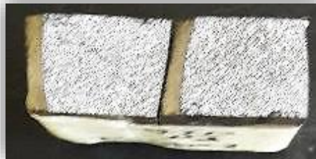
Figura 3.16. Fractura de la probeta con relación molar 0.36 | 1, 0.384%Ti. Se aprecia una fractura 100% frágil.
