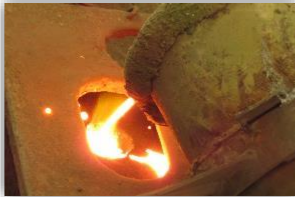
Figura 2.10. Vaciado de moldes.
