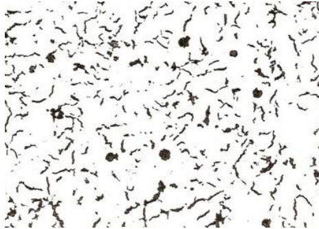
Figura 1.14. Microestructura de un hierro con grafito compacto (CGI) a 100 aumentos.
