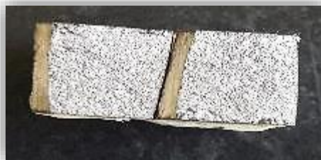
Figura 3.14. Fractura de la probeta con relación molar Mg/Ti 0.27| 1, 0.295%Ti. Se aprecia una fractura 100% frágil.
