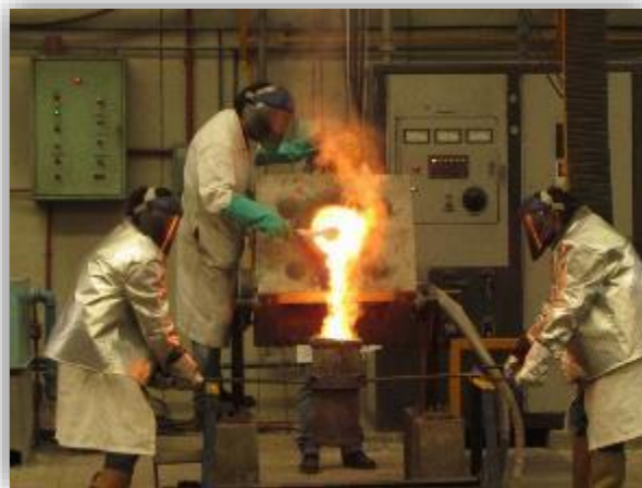
Figura 2.9. Tratamiento de inoculación al metal líquido.
