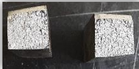
Figura 3.13. Fractura de la probeta con relación molar Mg/Ti 0.31| 1, 0.1223%Ti. Se aprecian defectos en ambas mitades, probablemente de escoria lo cual no permite un análisis confiable de la fractura; sin embargo, tendería a una fragilidad del 80%.
