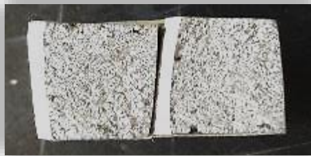
Figura 3.15. Fractura de la probeta con relación molar Mg/Ti 0.20 | 1, 0.371%Ti. Se aprecian algunos defectos y una fractura 90% frágil.
