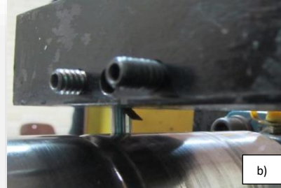
Figura 2.24. a) Vista frontal de la posición de la probeta de desgaste, b) vista lateral de la posición de la probeta de desgaste.
