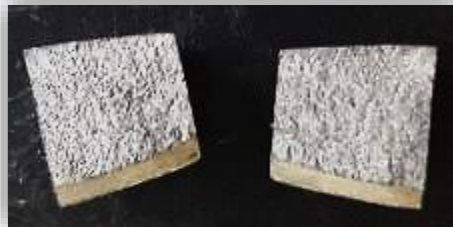
Figura 3.12. Fractura de la probeta con relación molar Mg/Ti 0.53| 1, 0.0913 %Ti. Se aprecia una fractura casi 100% frágil, con una superficie ligeramente rugosa en la esquina inferior derecha de ambas mitades.
