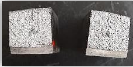
Figura 3.11. Fractura de la probeta con relación molar Mg/Ti 0.8| 1, 0.048 %Ti. Se aprecia una fractura 80% frágil, ligeramente rugosa con escasas marcas de playa.
