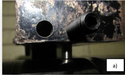
Figura 2.24. a) Vista frontal de la posición de la probeta de desgaste, b) vista lateral de la posición de la probeta de desgaste.
