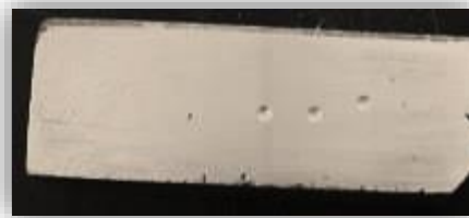
Figura 2.14. Huellas generadas durante el ensayo de dureza.
