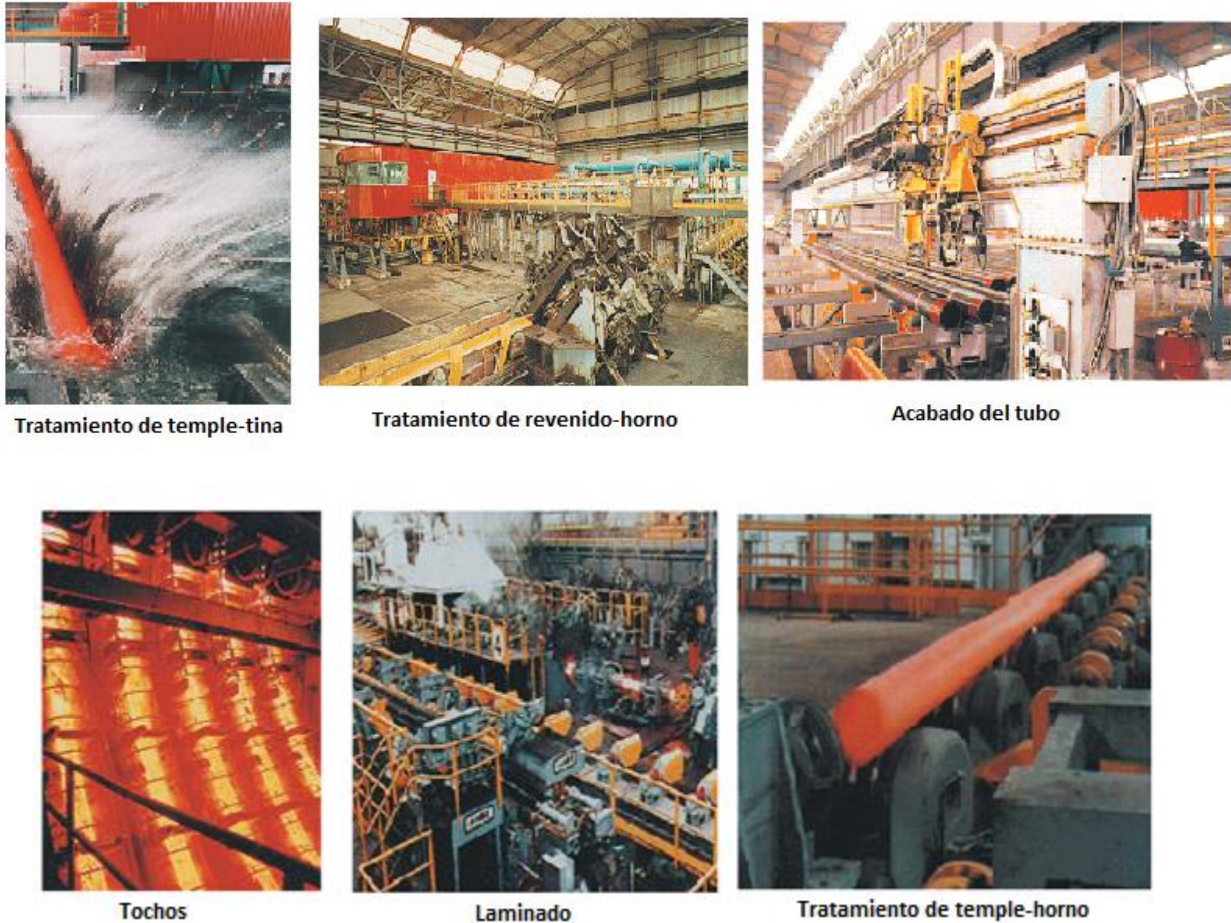
Figura 2.3 Proceso de fabricación sin costura (Pemex). Modificado.
