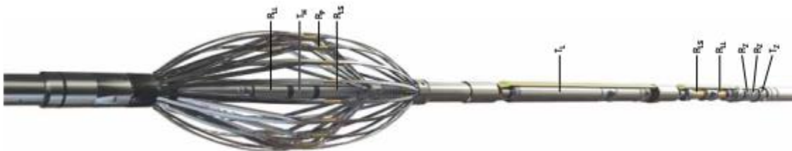
Figura 2.5 Herramienta electromagnética de Schlumberger (Acuña, y otros, 2010).
