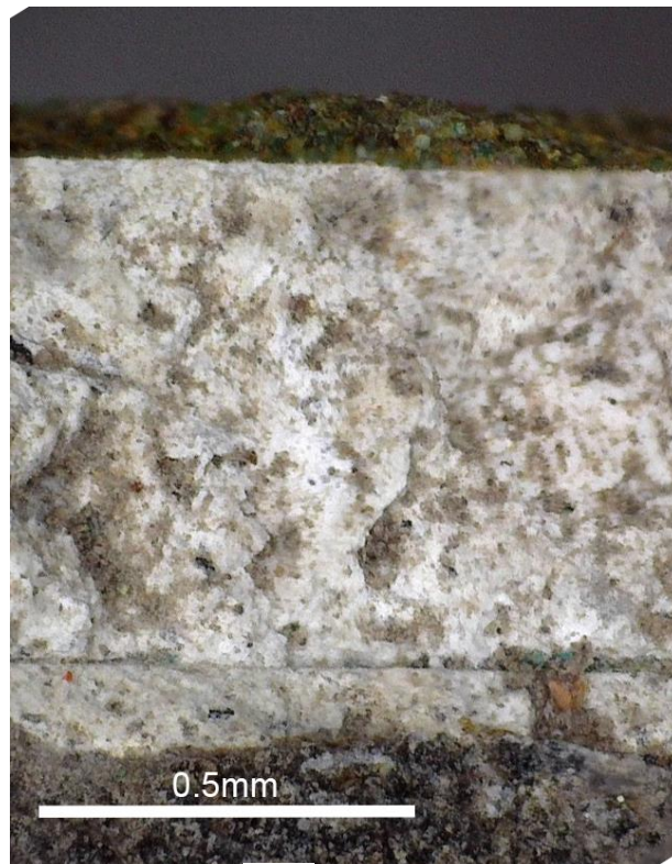
Figura 5-14: Evidencia de superposición de enlucidos en el fragmento D18-0613-02 en dos secciones distintas (a) y (b). Microscopía a 100X. Microscopía Paulina Guzmán
