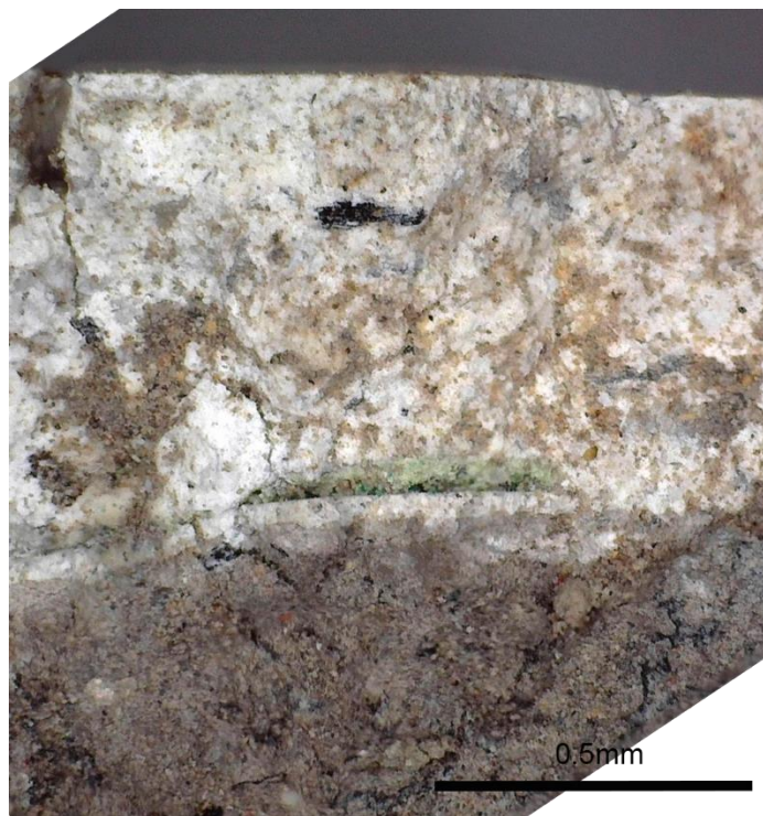
Figura 5-14: Evidencia de superposición de enlucidos en el fragmento D18-0613-02 en dos secciones distintas (a) y (b). Microscopía a 100X. Microscopía Paulina Guzmán
