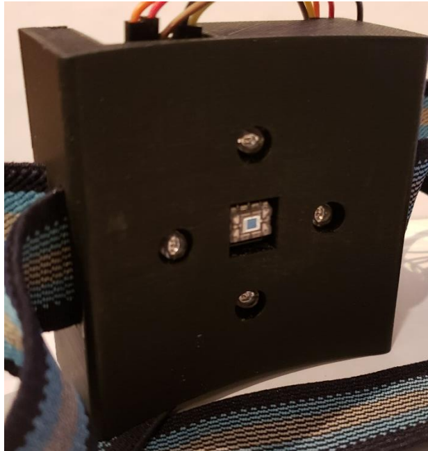
Figura 66. Encapsulado de la PCB del OPT101
