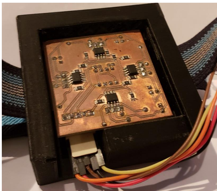
Figura 64. Vista superior de carcasa armada con placa PCB del OPT101
