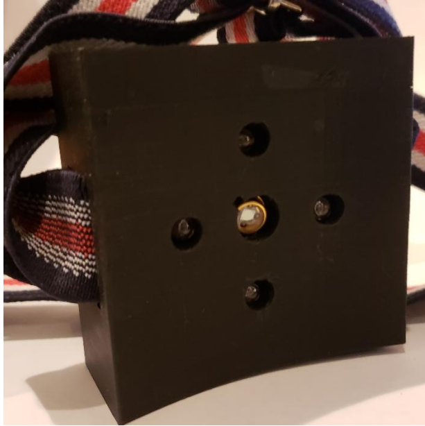
Figura 65. Encapsulado de la PCB del ODA-5W-100K
