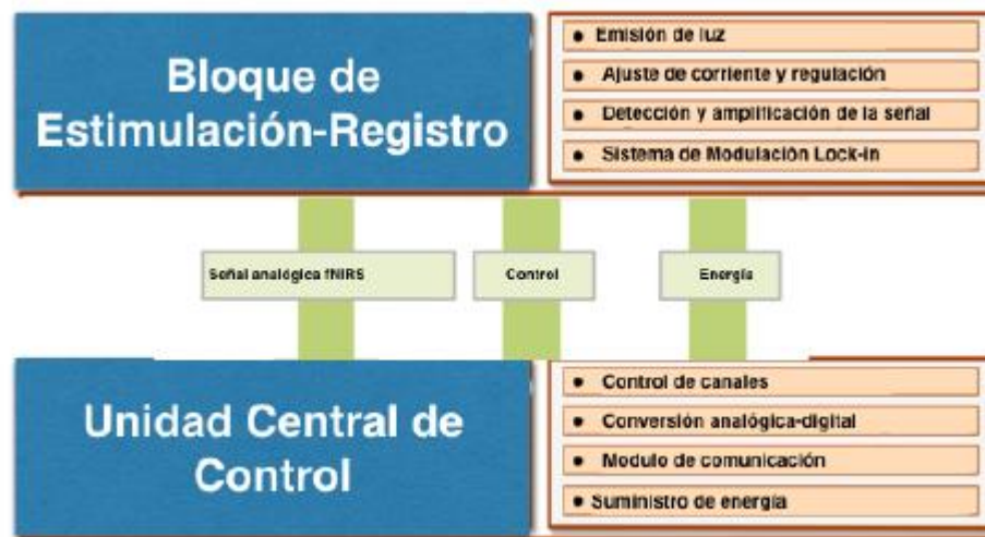
Figura 13. Principio de diseño modular del sistema fNIRS propuesto. Copyright 2015 von Lühmann et al con permiso.
