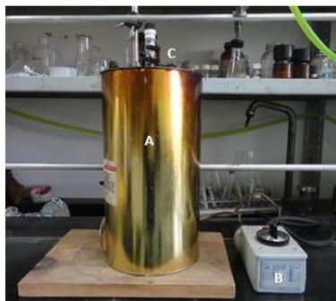
**Figura 23.** Equipo empleado para la síntesis de los 1-((3(4)-diindolilmetil)bencil)-2-(3(4)-diindolilmetilfenil)-1H-benzimidazoles. **A)** Contenedor con lámpara de infrarrojo. **B)** Reóstato, para regular temperatura. **C)** Tubo de reacción.
