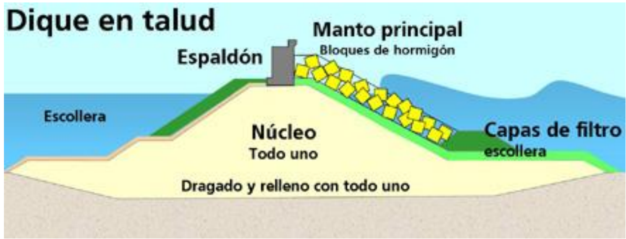
Figura. 11. Esquema de un dique en talud
