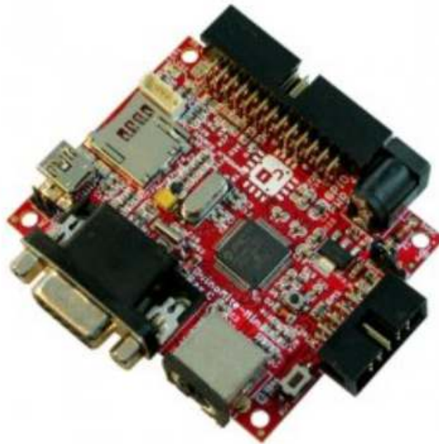
Figura 4.21 Minicomputadora Duinomite para adquisición de datos.
