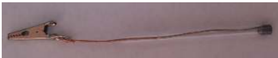
Figura 4.13 Electrodo de trabajo grafeno/wireglue.
