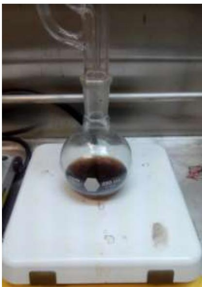
**Figura 35.** Coloración final de la disolución de tolueno usada en el procedimiento de lavado de la roca de yacimiento.
