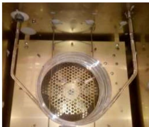
**Figura 38.** Columna de vidrio para cromatografía de gases, configuración para cromatógrafo Hewlett Packard 5890 serie II.
