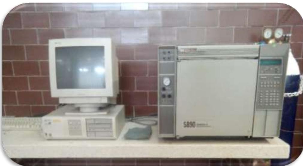
**Figura 13.** Cromatógrafo de Gases Hewlett Packar 5890 Serie II
