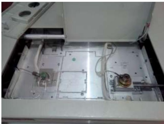
**Figura 43.** Adaptación del inyector del cromatógrafo Hewllet Packard 5890 serie II
