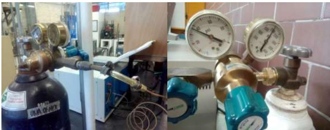
**Figura 42.** Adaptación de los reguladores de flujo adecuados para cada gas
