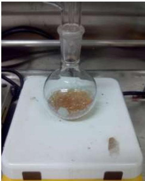
**Figura 32.** Disolución de aminas contaminada por el aceite embebido en la roca de yacimiento.
