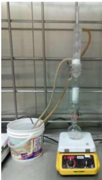
**Figura 30.** Sistema Soxhlet con refrigeración y trampa de vapor
