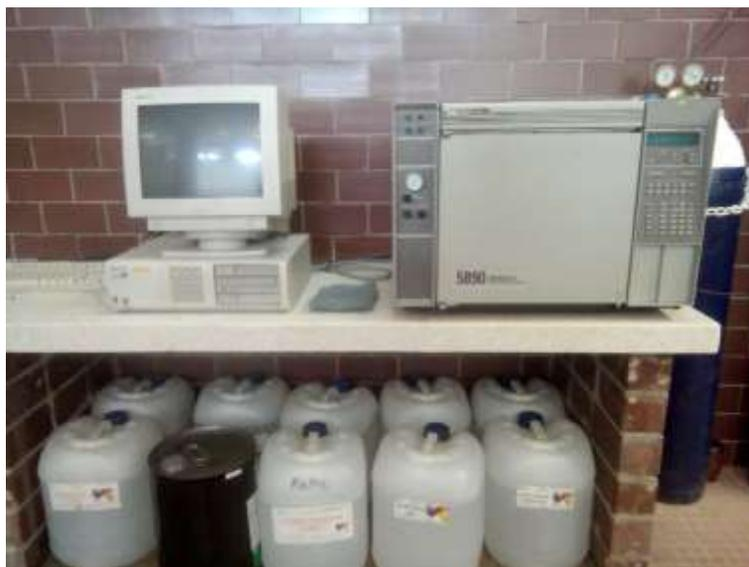
**Figura 46.** Cromatógrafo de gases Hewlett Packard 5890 serie II
