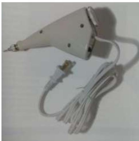
**Figura 39.** Vibrador para empacar columnas de vidrio y metálicas para uso cromatográfico.
