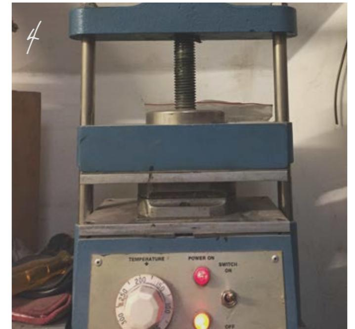
5. Introducir las otras láminas de caucho, las últimas capas deben tener un sobrante y rebasar el nivel del marco para que al ejercer presión con la vulcanizadora todas las capas de caucho se compriman y el molde pueda tener una buena consistencia.
