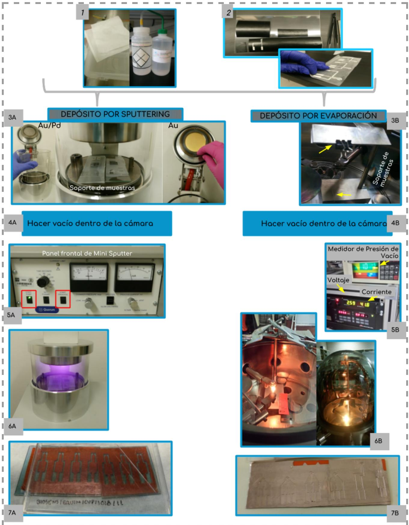
Figura 47. Esquema del protocolo 2 de fabricación de electrodos.
