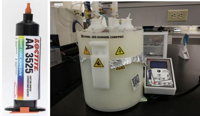
Figura 40. Izquierda: Envase del adhesivo fotopolimerizable Loctite 3525. Derecha: Spin Coater Laurell WS-650-23.
