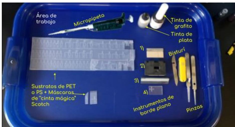
**Figura 51.** Materiales y herramientas usados en las pruebas de fabricación de arreglos de grafito y plata (Parte 1). Los instrumentos de borde plano probados fueron: 1)navaja de acero inoxidable teflonada, 2)mini-rodillo de acero inoxidable, 3) barra de goma, 4) acrílico.
