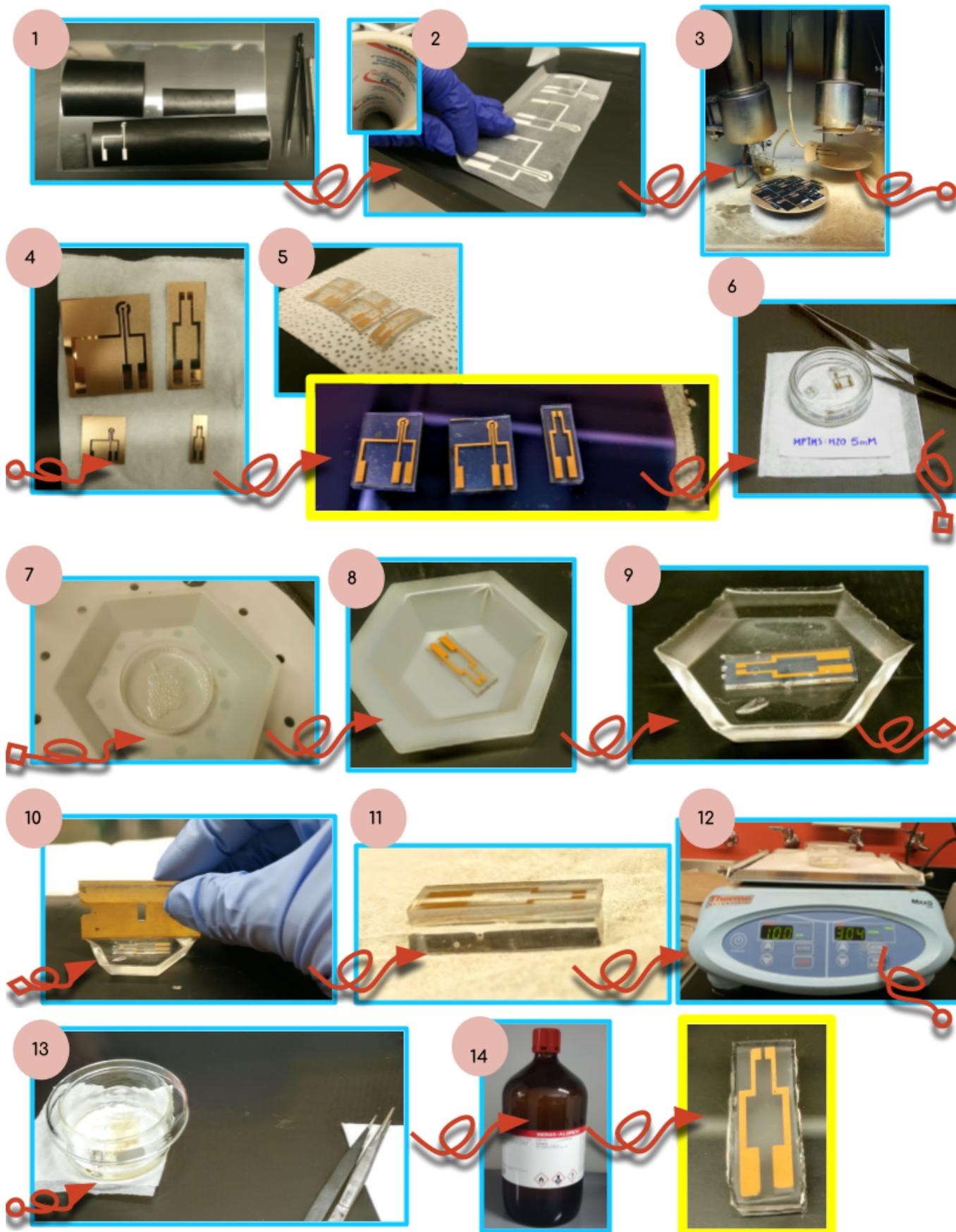
Figura 59. Esquema de los pasos para obtener electrodos de alta rugosidad de oro sobre poliestireno.
