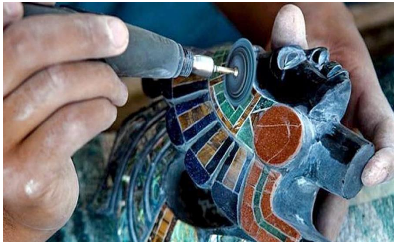
Imagen 25. Pieza decorada con un disco para pulido. Al igual que la imagen anterior, sobresalen los detalles curvos que posibilitan los discos más pequeños. Fuente: Alianza Anahuaca.
