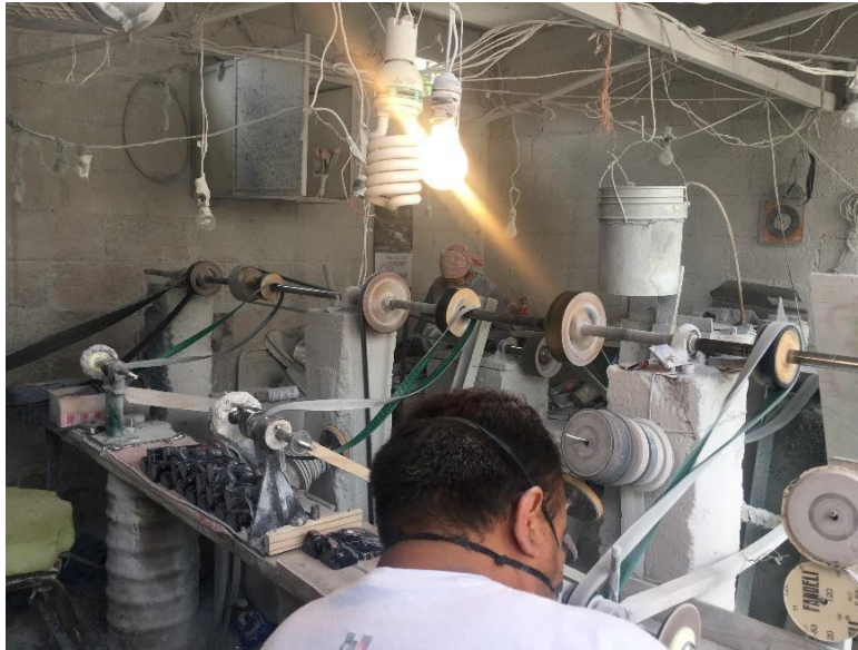
Imagen 16. Seis estaciones para fletear y pulir. Cada par tiene un contacto hacia la luz y para evitar que se accionen ambas mientras sólo se utiliza la otra, se retira la banda que las conecta. Taller de Viridiana López, 21 de abril de 2018.
