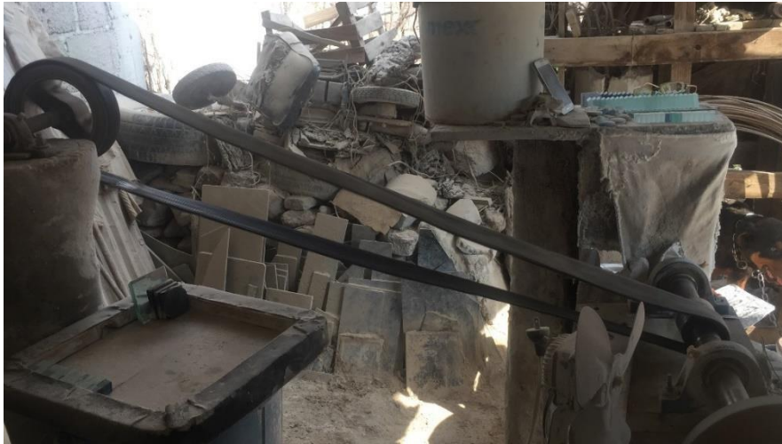
Imagen 15. Estación del taller para fletear compuesta de dos ruedas en los extremos y una banda. Al ponerse en movimiento la rueda izquierda, la banda mueve el tubo o flecha del lado derecho para accionar los discos de pulido. Taller de Pedro Martínez.
