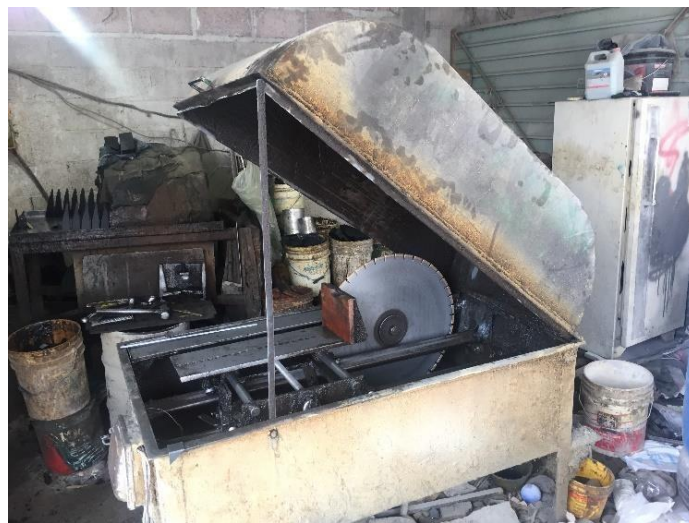
Imagen 14. Máquina manual cortadora de bloque obsidiana. Se coloca el bloque del lado izquierdo y, al accionar por medio de la luz, se mueve automáticamente de izquierda a derecha mientras el disco hace un corte. Taller de Viridiana López, 21 de abril de 2018.
