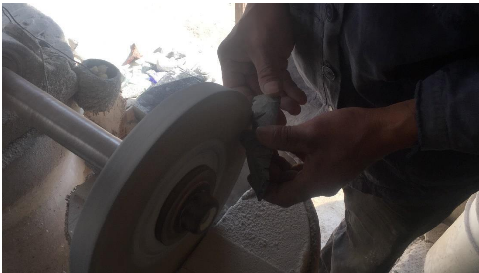
Imagen 18. Pedro Martínez dando los últimos detalles del fleteo a una pieza en su taller. A pesar de la velocidad de los discos, se requiere aplicar fuerza a través de la pieza para dar estabilidad al corte, 23 de enero de 2018.
