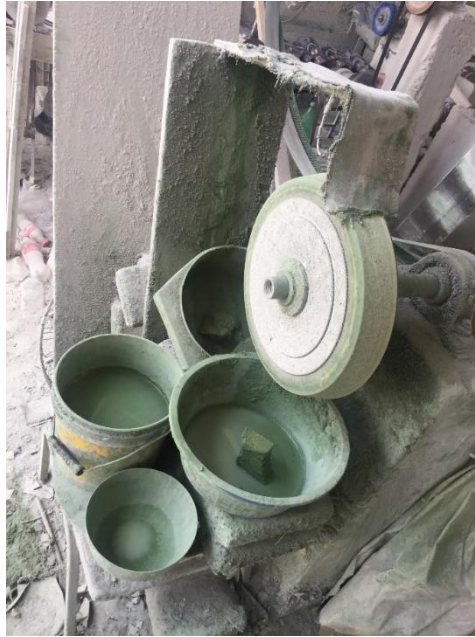
Imagen 30. Zona de acabado con polvos químicos de color verde mezclados con agua. Se remoja la pieza en las cubetas del costado y se pule el disco. La cubeta inferior es en donde se deposita la rebaba que puede ser reutilizada al menos dos veces. Taller de Viridiana López, 21 de abril de 2018.
