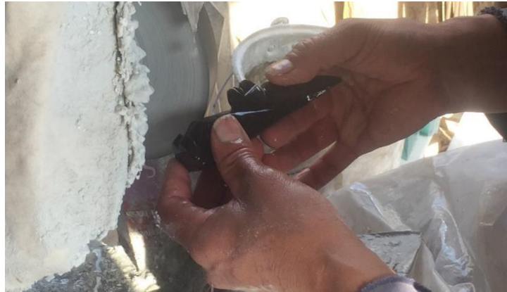
Imagen 21. Emparejado de pieza con agua, la cual permite que se aprecien mejor los cortes y sean más finos. También permite que, en lugar de polvo, se produzca rebaba de la pieza. Taller de Pedro Martínez, 23 de enero de 2018.
