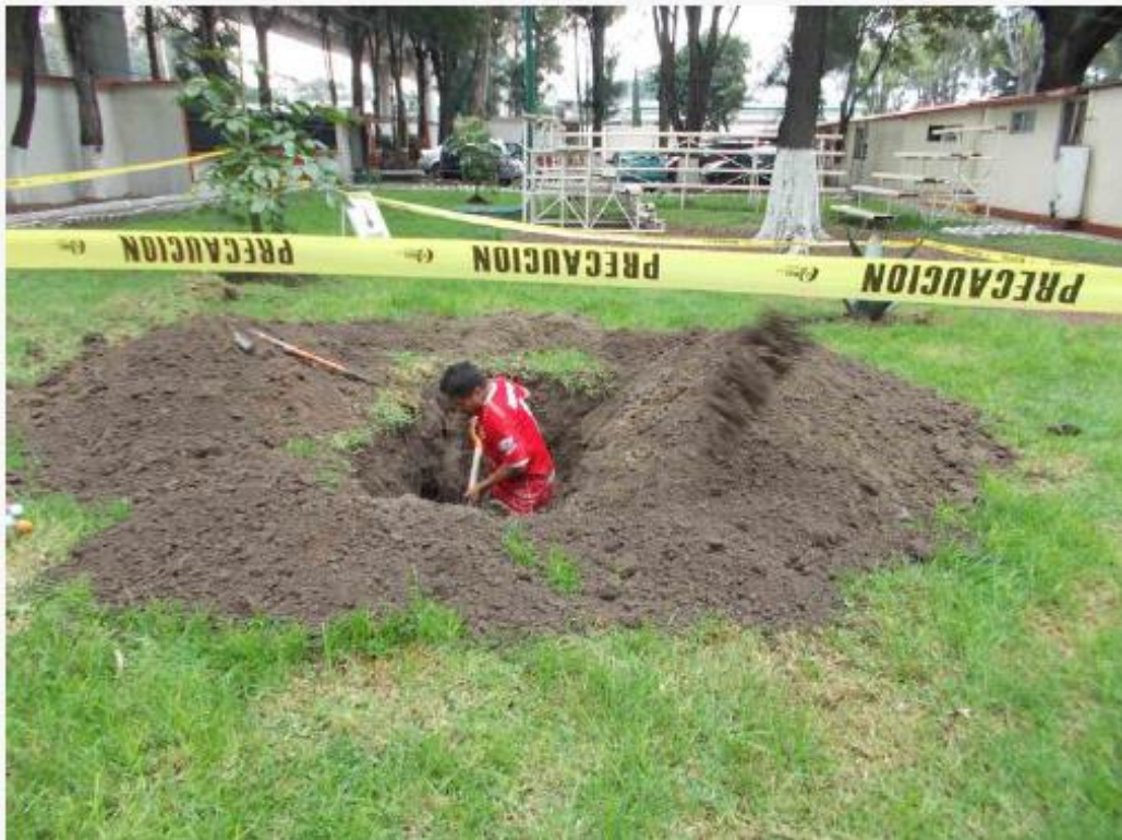
Figura A. 12 Pozo a Cielo Abierto.
