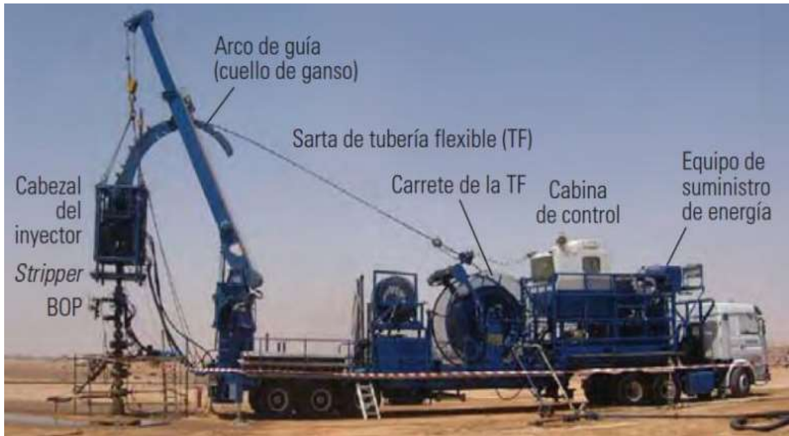
Equipo de perforación con Tubería Flexible
