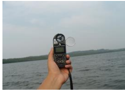
Fig. 5. Estación Climática Kestrel 4000.
