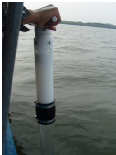
Fig. 10. Obtención de sedimento con Nucleador universal Watermark.
