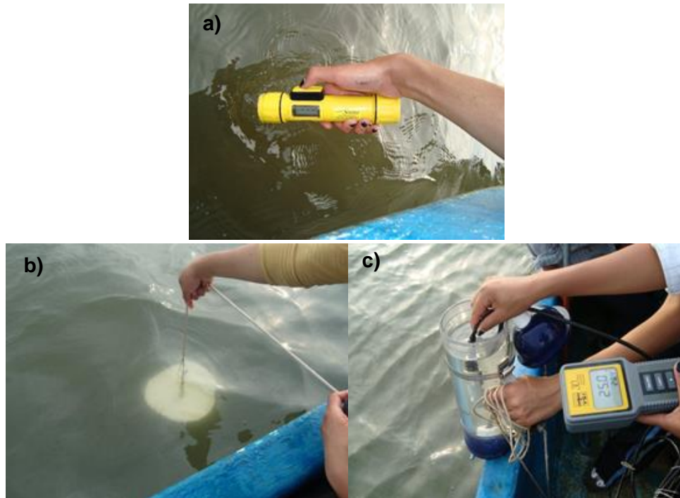
Fig. 7. (a) Ecosonda Depthmate, SM-5, (b) disco de Secchi LaMotte y (c) botella de Van Dorn para características hidrológicas de fondo.
