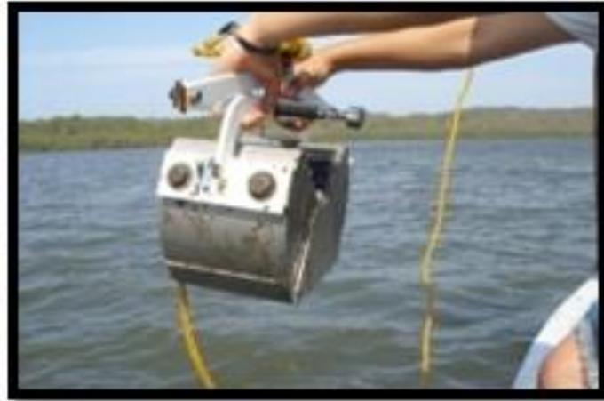
Fig.19. Draga AMS para aguas poco profundas.
