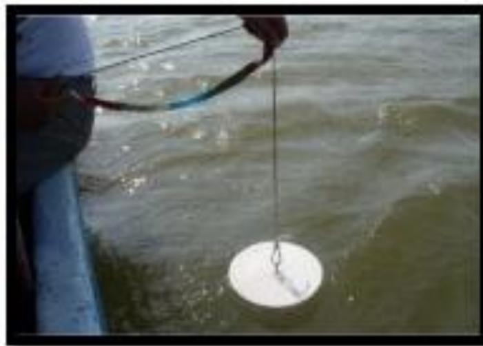
Fig. 11. Disco de Secchi LaMotte con cinta métrica.
