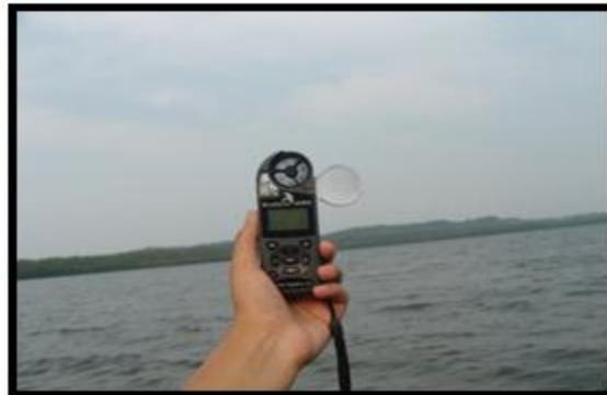
Fig. 7. Estación Climática portátil Kestrel 4000.
