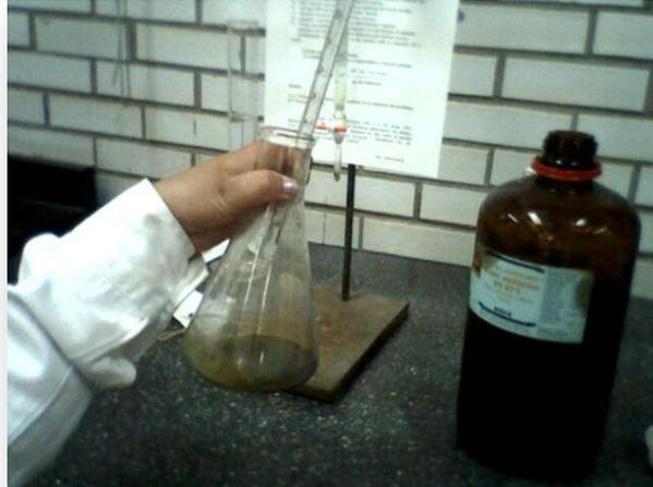
Fig. 20. Coloración verde adquirida por la técnica de oxidación crómica.
