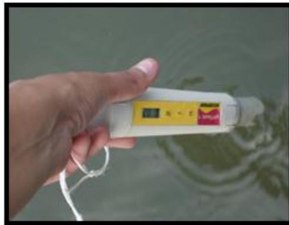
Fig. 15. Potenciómetro Waterproof pH Testr.
