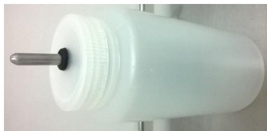
Figura 11. Bebedero de botella y tapa de polipropileno, con pipeta de acero inoxidable.
