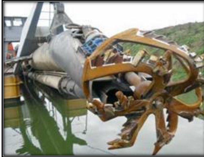
Imagen 24. Características del cutter y suction de una draga.
