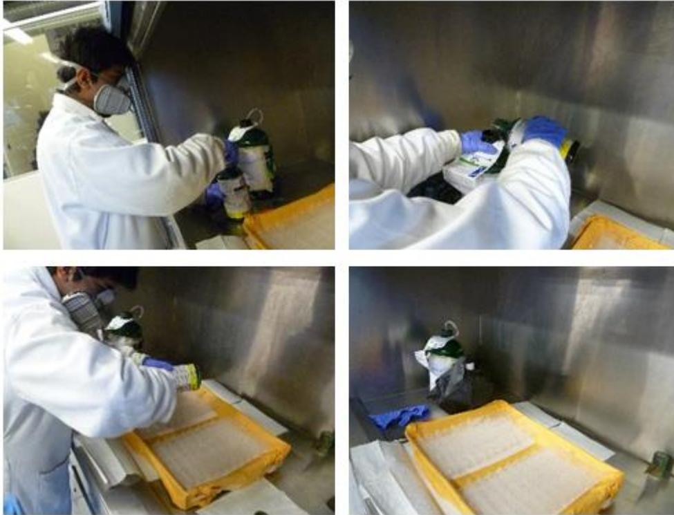
Figura 16. Vaciado de envase, enjuague, cortado y envase cortado dentro del soporte de muestra
