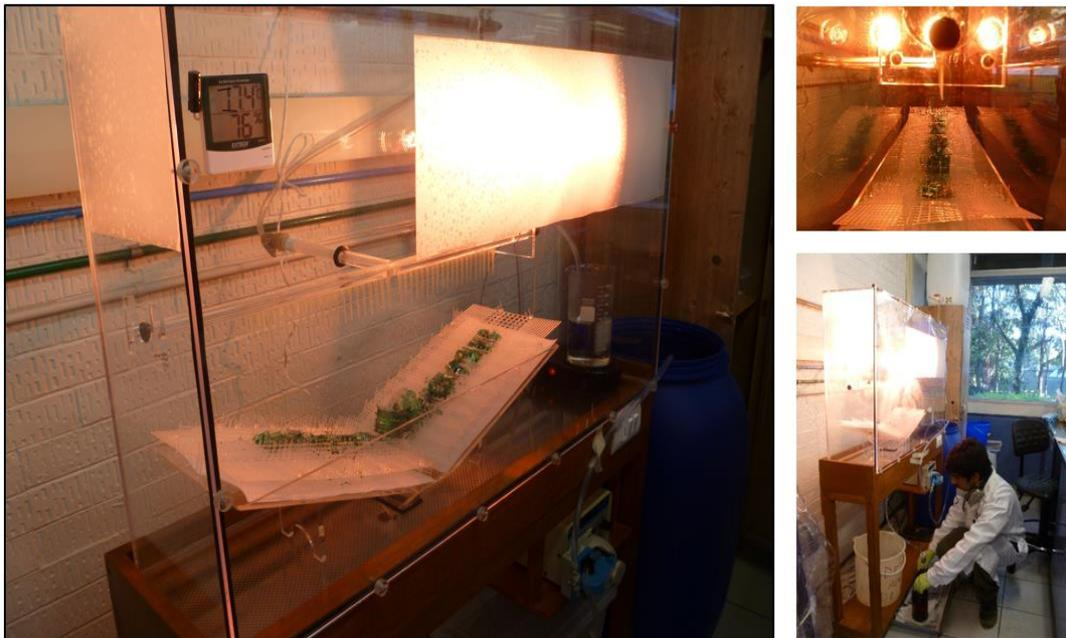
Figura 13. Operación de la cámara de lixiviación acelerada
