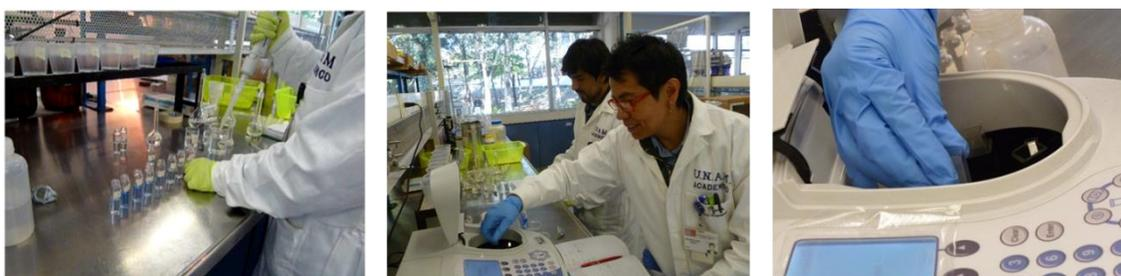
Figura 20. Preparación de las disoluciones del derivado de paraquat y las lecturas en el espectrofotómetro
