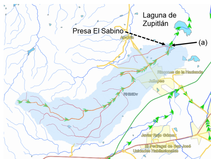
Figura 4.8: En la imagen se muestra la microcuenca de influencia de la presa El Sabino, obtenida con el software en línea SIATL de INEGI.
