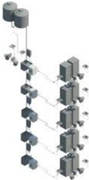
Figura 9. Tubería de agua fría de sección A
