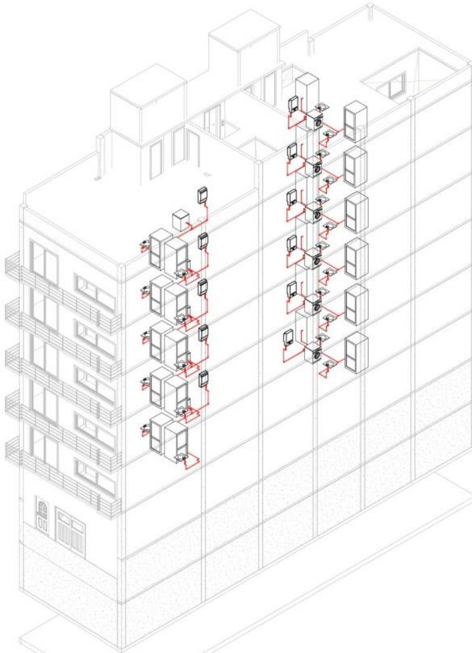
1 isométrico tubería de agua caliente
