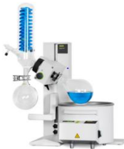
Montaje experimental para la destilación a presión reducida en un Rotavapor.
