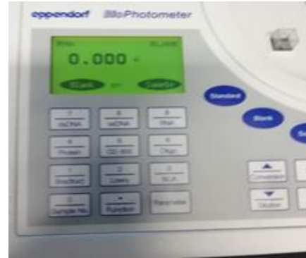
Fig.4. Ajuste de absorbancia con el blanco de concentración.
