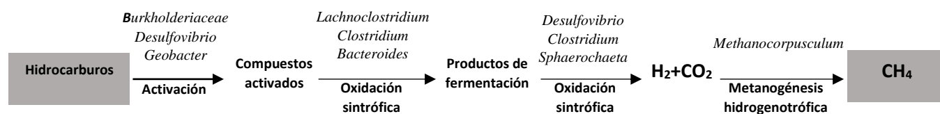
Figura 23. Posibles microorganismos involucrados en los diferentes pasos de degradación de hidrocarburos bajo condiciones metanogénicas en el consorcio enriquecido
