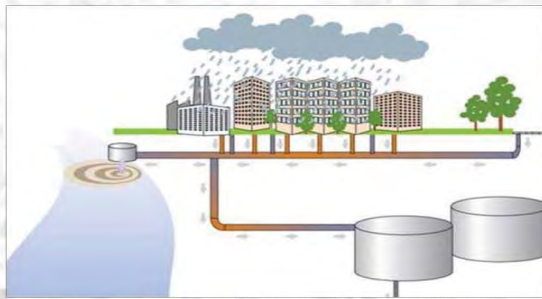
Figura 43. Funcionamiento de red de drenaje.
