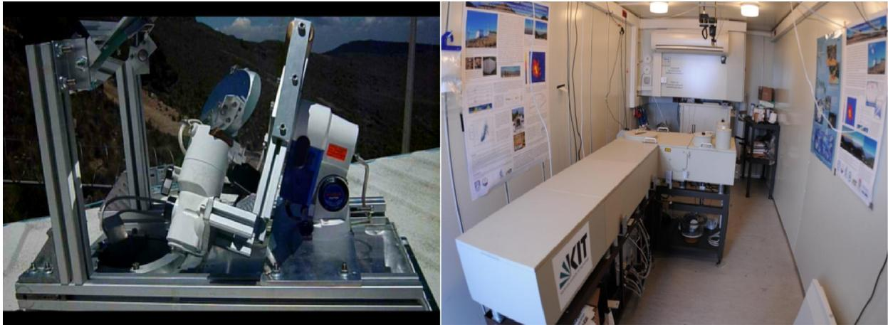
**Figura 3.5:** Experimento FTIR en Altzomoni. A la izquierda se observa el rastreador solar mientras que a la derecha el espectrómetro FTIR 120/5 HR.
