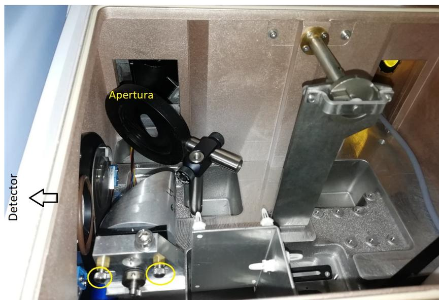
**Figura A.5:** Vista superior de la apertura a la salida del interferómetro del Vertex80.
