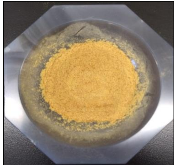
Fotografía 17. Fase Polvo del Sistema Mixto de \text{SiO}_2\text{-TiO}_2 con Acetilacetona.
