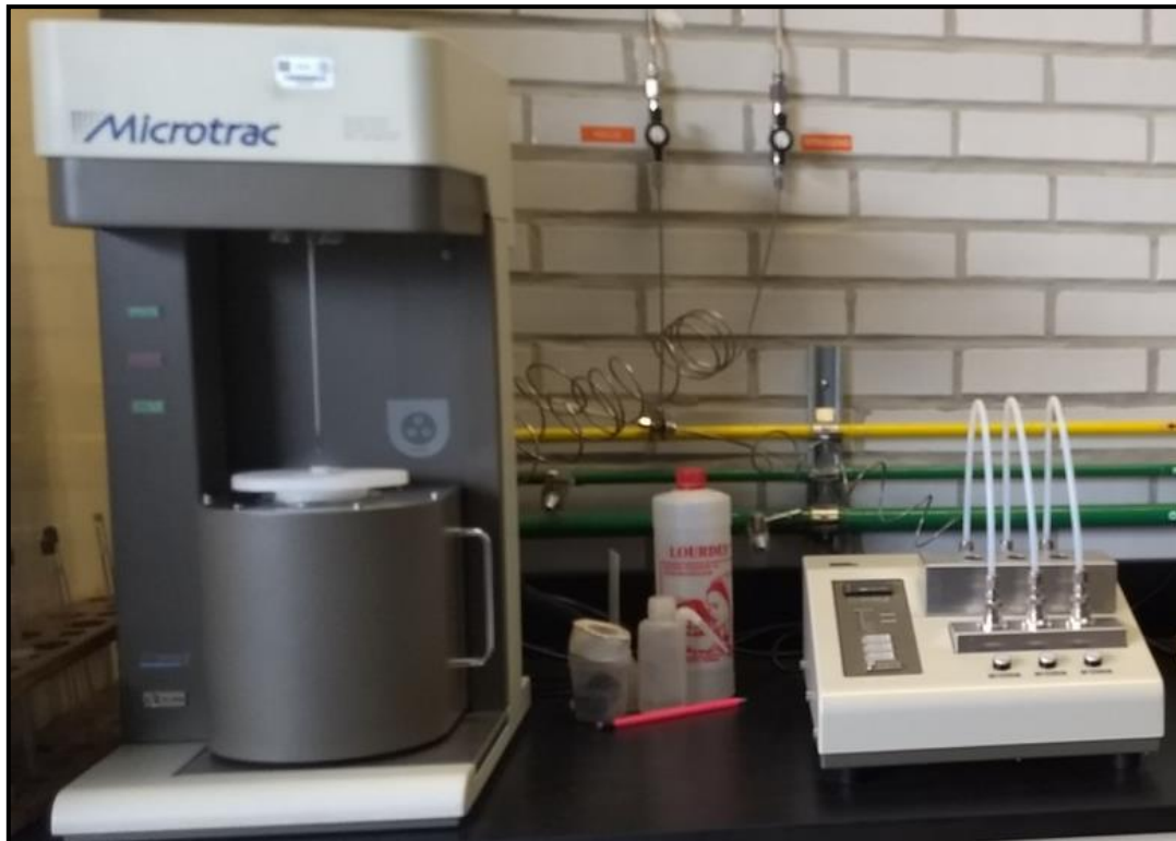
Fotografía 24. Equipo de Propiedades Texturales, de la Marca Bell Japan y desgasificador utilizando Helio molecular y Nitrógeno como adsorbato.
