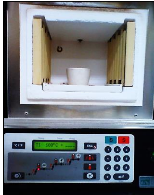
Fotografía 21. Calcinación de las muestras en fase polvo.
