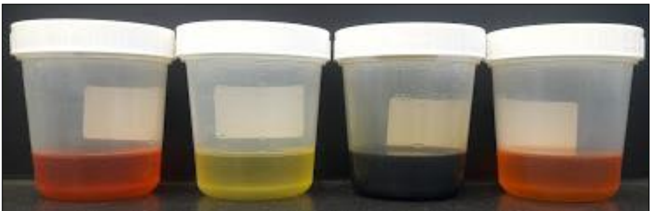
Fotografía 8. Sistema Mixto de \text{SiO}_2\text{-TiO}_2 incorporando a los sistemas Isoeugenol, Acetilacetona, Catecol y Anhídrido Itacónico.
