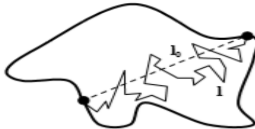
Figura 10. A partir de la figura, definamos la tortuosidad como: T=l/l_0 . Como es de esperar, T depende de \phi . Sí \phi es muy baja, T es muy grande. Generalmente T no puede ser medido experimentalmente y en la mayoría de los modelos clásicos de flujo y transporte en medios porosos lo tratan como un parámetro ajustable. [26].
