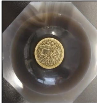
Fotografía 9. Xerogel Mixto de \text{SiO}_2\text{-TiO}_2 con Anhídrido Itacónico.
