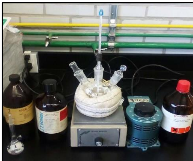
Fotografía 3. Sistema de reacción para la síntesis del Sol A2.
