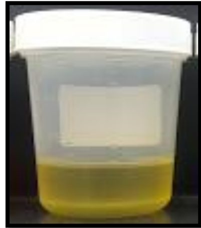
Fotografía 6. Sol Mixto de \text{SiO}_2\text{-TiO}_2 utilizando como Agente Quelante a la Acetilacetona.
