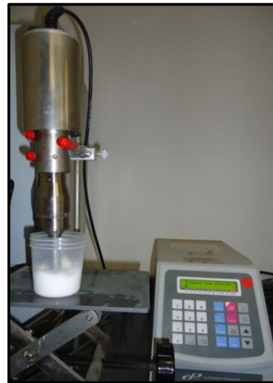
Fotografía 7. Aplicación de Ultrasonidos de Alta Frecuencia de la marca Cole Parmer Modelo CPX 750.
