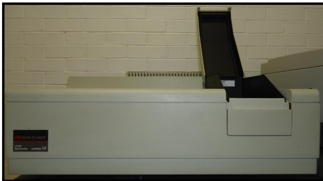
Fotografía 22. Equipo de Ultravioleta Visible (UV-Vis), de la Marca Perkin Elmer, Modelo Lambda
